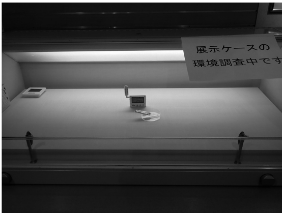
写真3 常設展示室簡易ガス濃度測定状況
