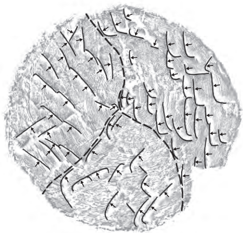
Fig. 224 81材 底面の拓本と加工痕 (矢印は刃の向き) 1:4
