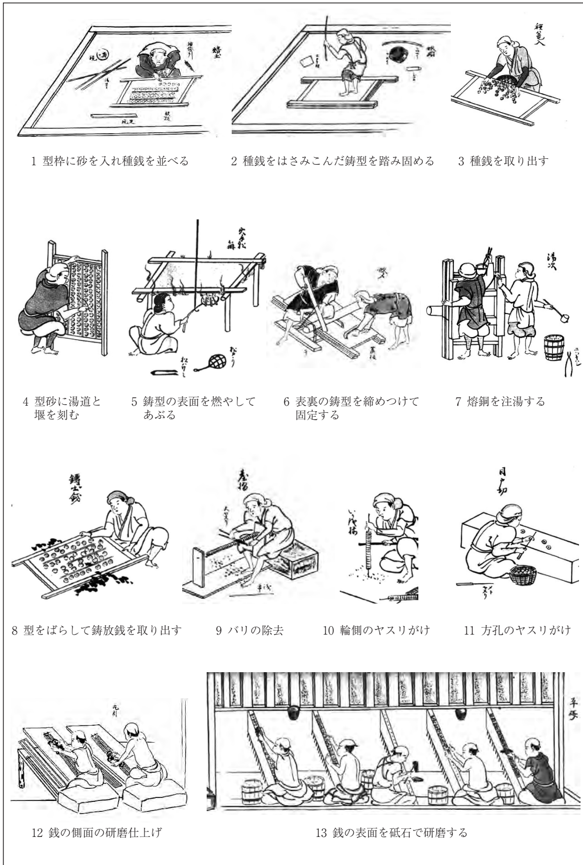
Fig. 258 寛永通寶の製作工程 (『鑄銭図解』)
