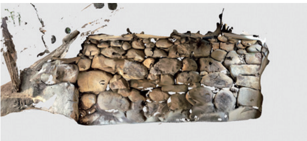
図7 iPadによるLiDAR計測した関西学院構内古墳の墳丘と石室。初めて操作する学生が計測。墳丘は20分程度、石室は10分程度の作業
