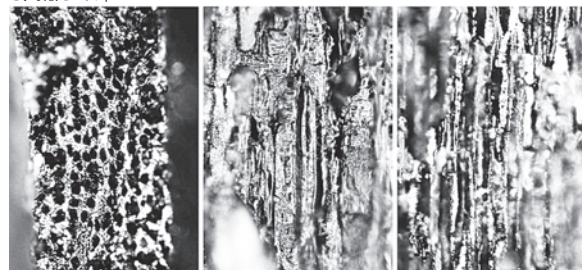
横断面 : 0.4mm 放射断面 : 0.2mm 接線断面 : 0.2mm 2. No. 8 カツラ
