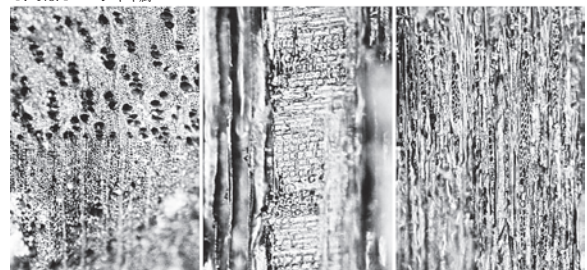
横断面 : 0.4mm 放射断面 : 0.2mm 接線断面 : 0.2mm 5. No. 3 エゴノギ属
