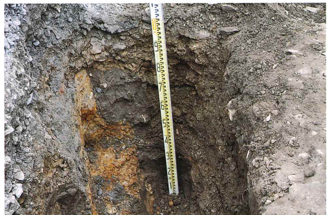
⑧テストピット、築城時石垣裏込め黒褐色粘土層 (北から)
