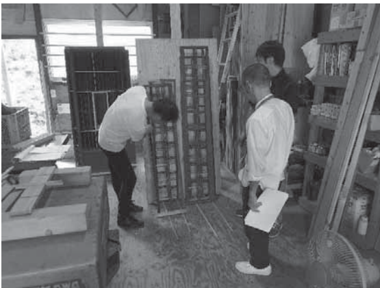
写真 4-68 修理建具検査 (協力会社 李工舎徳長加工場)
