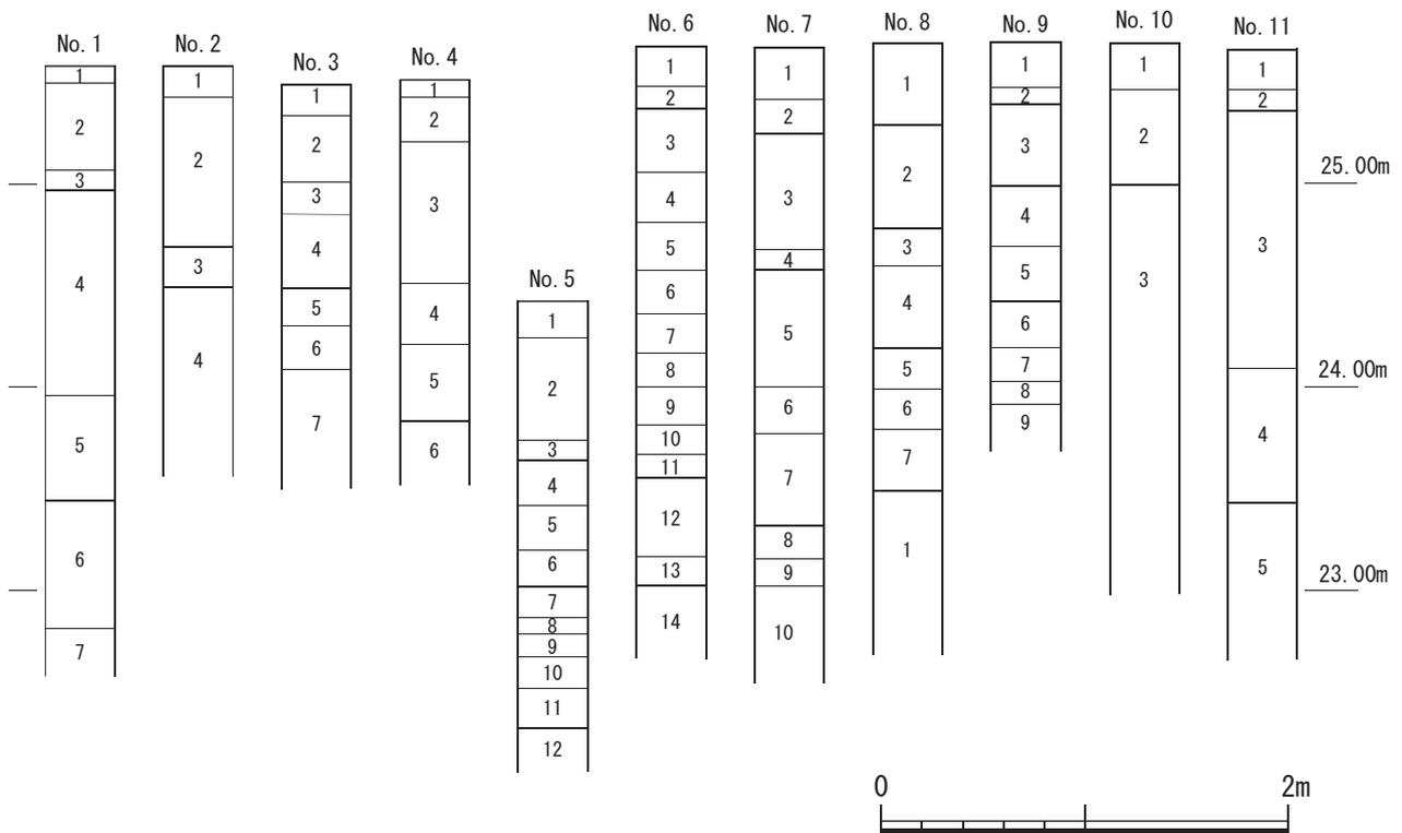
第12図 ボーリング調査土層柱状図 (1 / 40)
