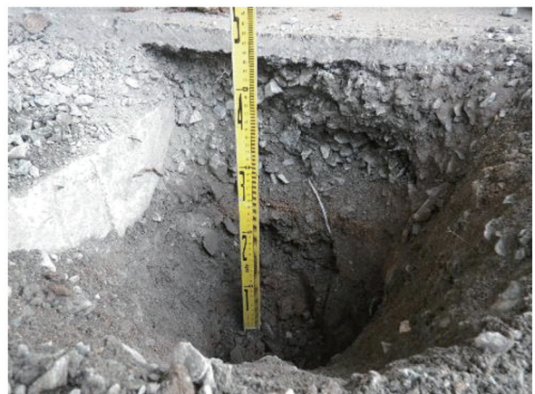
地点2 フェンス基礎A 土層断面
