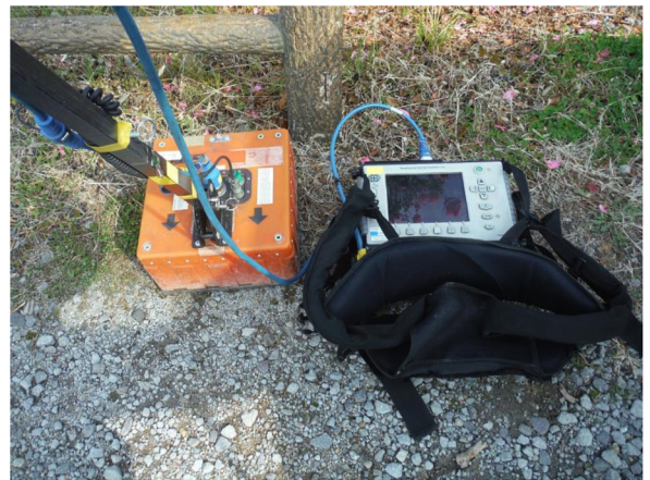
使用機材 (測定器：SIR-3000、アンテナ：400MHz)
