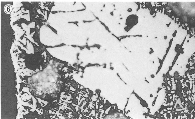
Photo.8 粒状滓様遺物の顕微鏡組織
