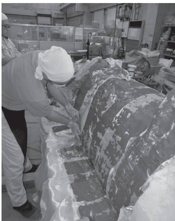
fig.145 下半部バックアップ設置作業
