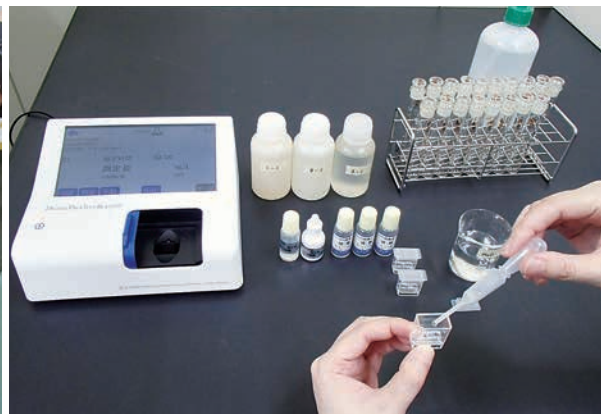
● 塩化物・硫酸濃度測定
