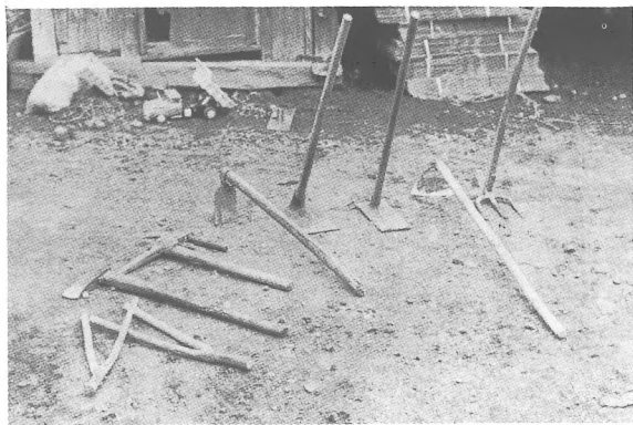
左より、ベエ（ボウチンボウでたたいた仕上げ用）マサキリ、ツルハシ、トウグワ、アラックワ、サクギリグワ、クサカキ、ピッチユウ、（大前）（関口正己撮影）
