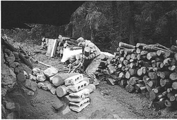
15 神丸、炭材の詰め込み作業
