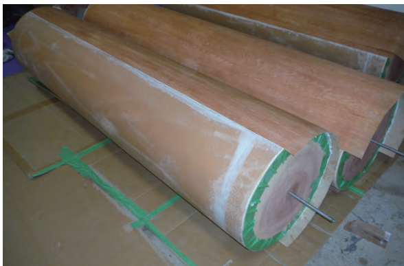
写資 1-19 柱素材木目シート貼付 2
