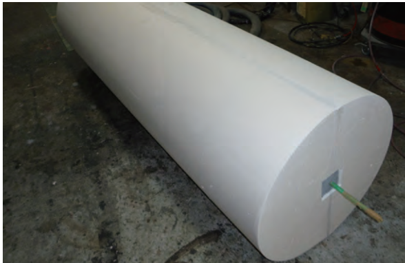
写資 1-17 柱素材（ポリウレタン樹脂成型品）
