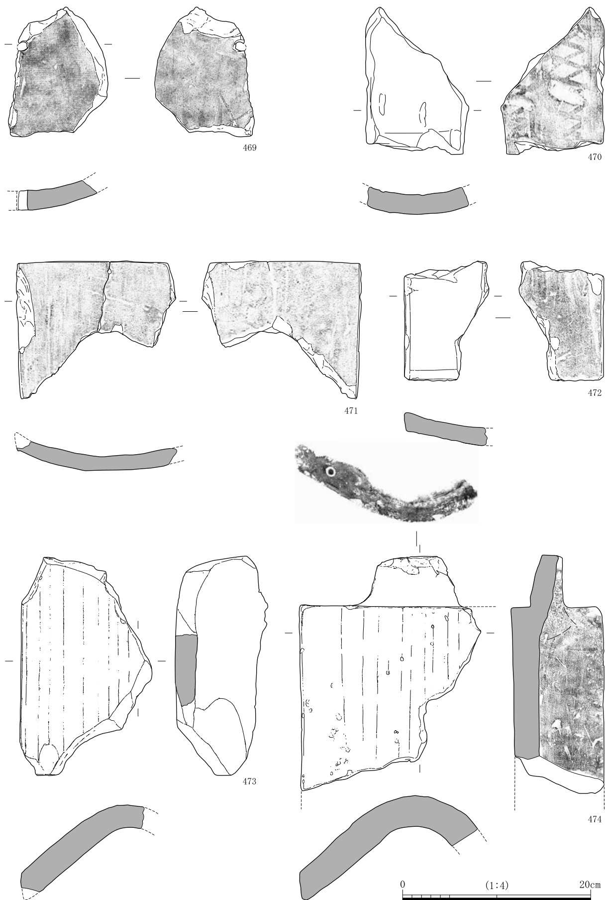
图 52 782 沟下层出土瓦实测图
