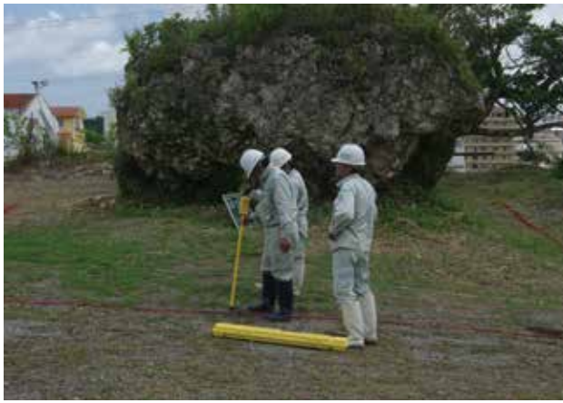
1. 磁気探査作業（トレンチ10）
