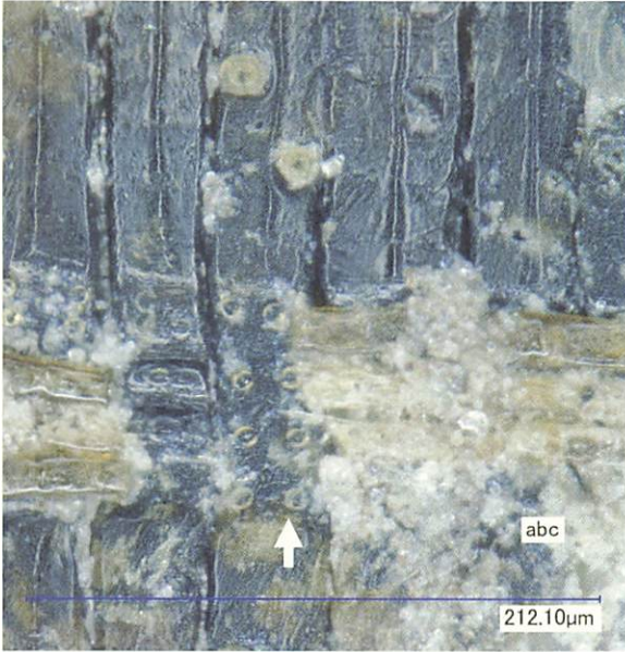
図1 底板の柾目面 分野壁孔 ×1000
