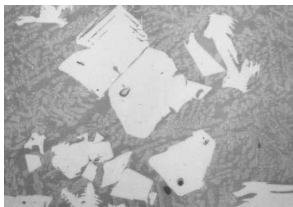
鉄滓頭微鏡組織写真 No.7-2 ×400
