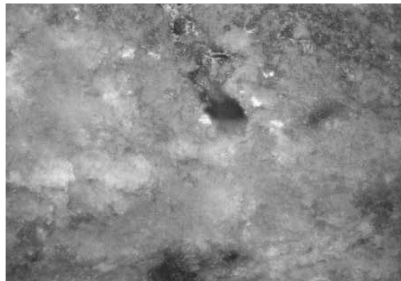
鉄滓頭微鏡組織写真 No.8-1 ×400
