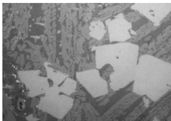
鉄滓頭微鏡組織写真 No.2-2 ×400
