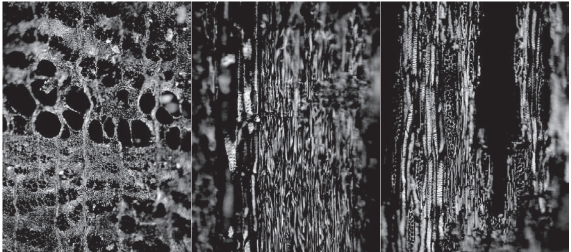
横断面 0.1mm 放射断面 0.1mm 接線断面 0.1mm ニレ属 試料番号33 IIIH-11 覆土中
