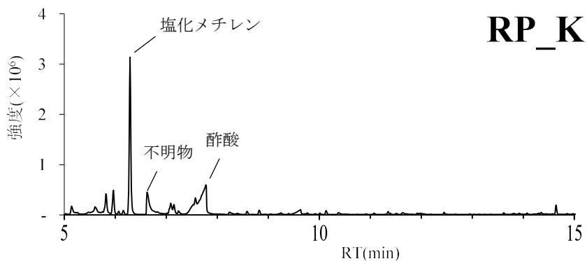
**a** 脱酸素剤 K 由来揮発成分の GC-MS スペクトル
