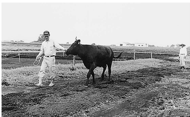
土マットを使用している牛歩行実験状況
