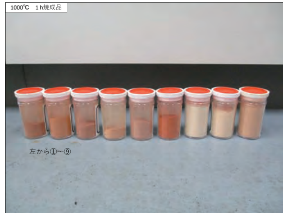
図 14 1000°C 1時間焼成した試料①～⑨
