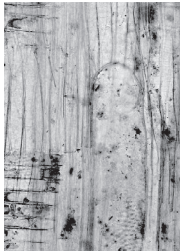
横断面 : 0.2mm 放射断面 : 0.1mm 接線断面 : 0.2mm 3. FB.015 94土坑 梯子 トチノキ
