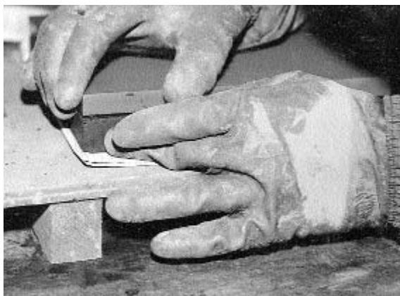
図 2 - 10 鑄型と原型を剥離する
