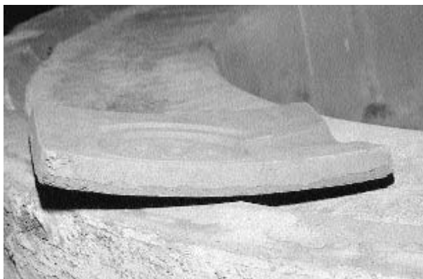
図3-23 パイメタルのように湾曲した二層式鑄型
