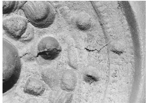
図4-20 鑄型Uのひび
