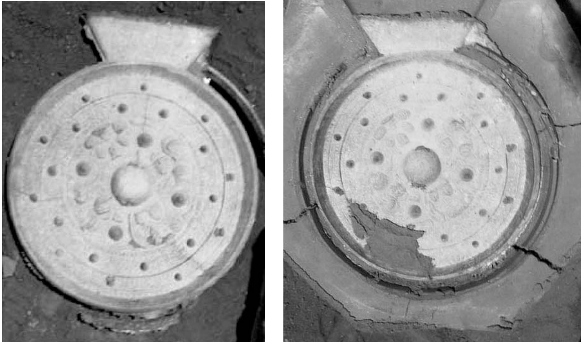
図3 - 41 復元した原寸大鏡（鑄込み直後）
