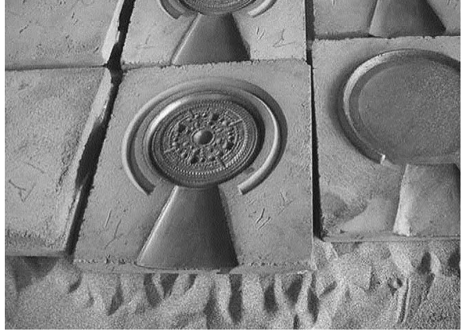
図3 - 2 黒鉛を塗って乾燥中の鑄型
