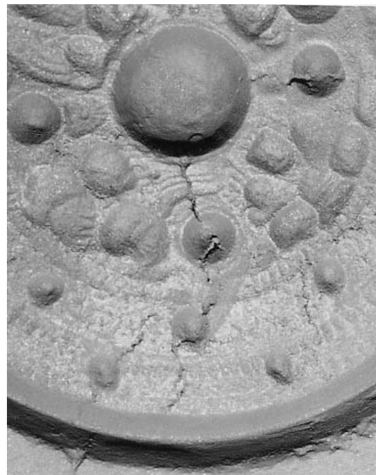
図3 - 25 ひびが入った二層式鑄型の表面（鑄型U） 上段と下段左は、乾燥後・焼成前、下段右は乾燥・焼成後
