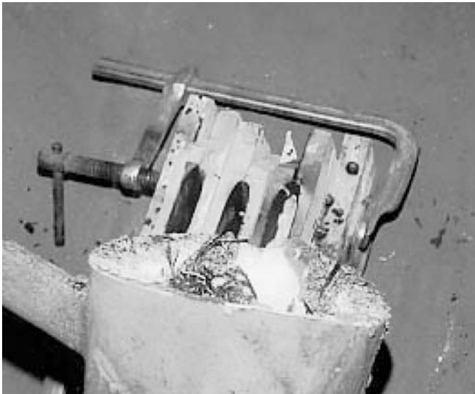
図3-10 鑄込み時、鑄型の中で泡が立っているところ
