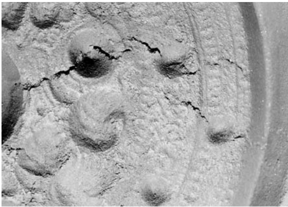
図4-19 鑄型Uのひび
