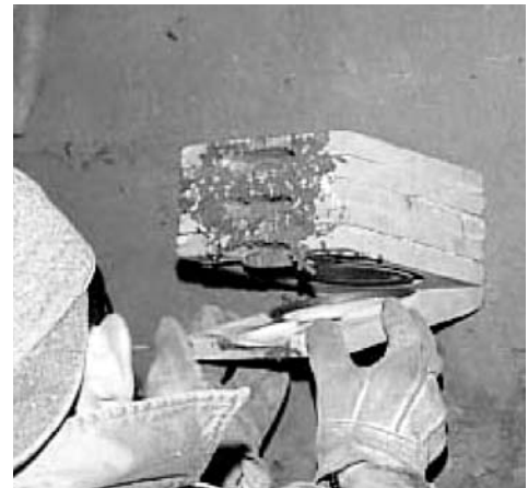
図3-11 鑄型の取り外し
