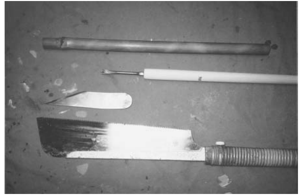
写真7 素材の篠竹と加工用具 (ねずみ刃錐・切り出し・ノコギリ)
