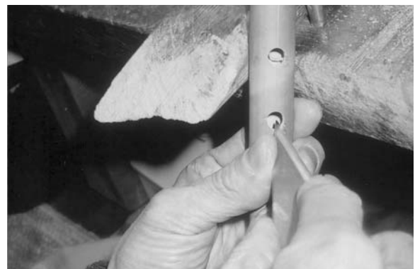
写真10 切り出して孔を整形する
