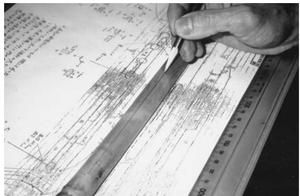
写真8 寸法図を基に各孔の位置を決める
