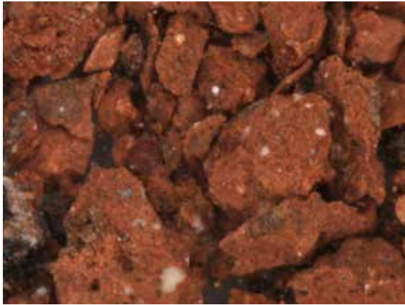
図1 No. 27の実体顕微鏡写真 (x40) 赤褐色の中に白粒・黒粒が認められる。
