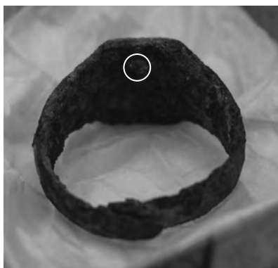
図 175 銅合金製指輪の鉛同位体比測定用試料採取箇所（○印）
