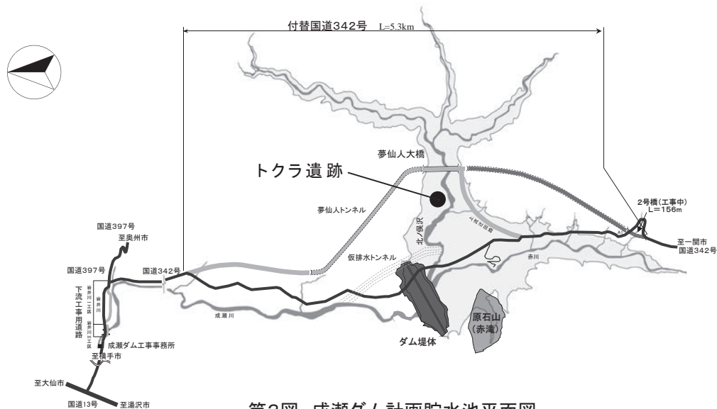
第3図 成瀬ダム計画貯水池平面図
