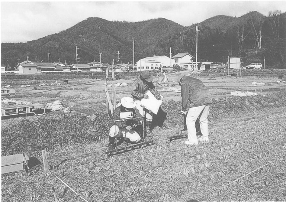
図2 電気探査作業状況
