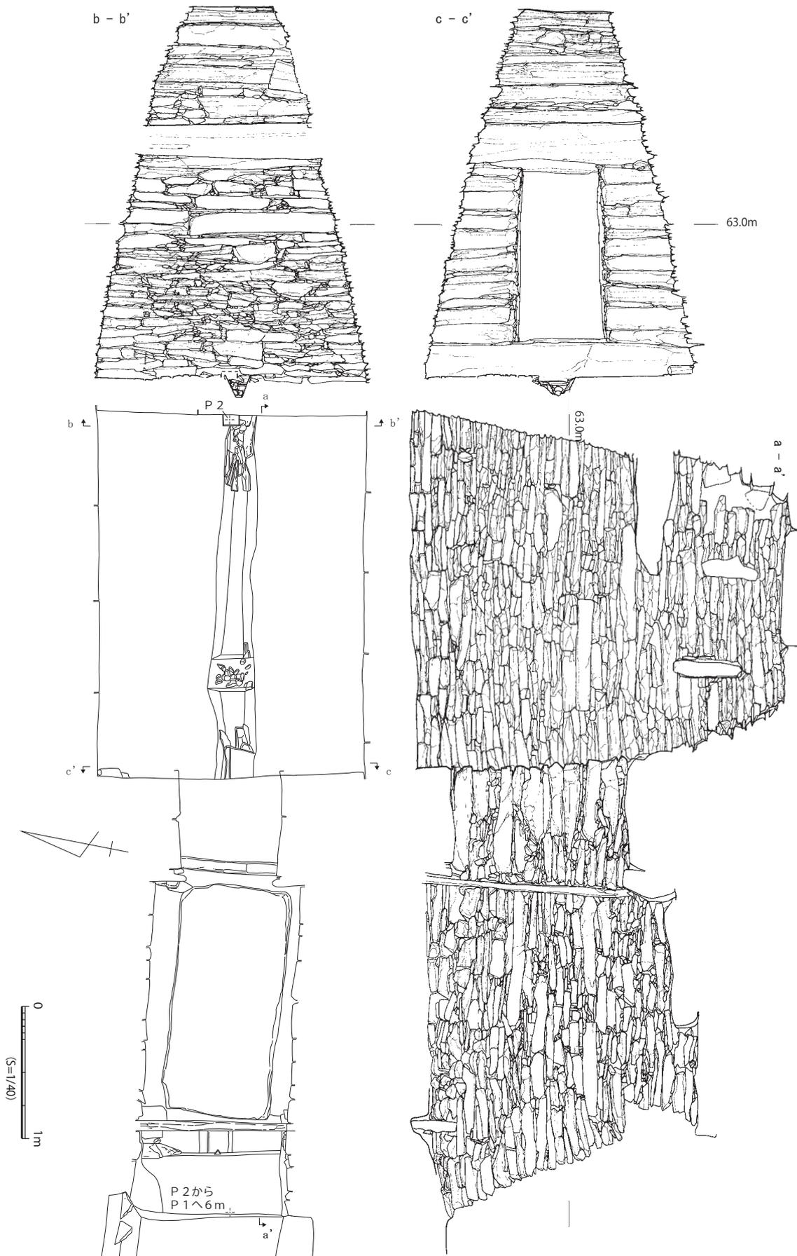
図 37 前山 A 13 号墳 横穴式石室実測図 (S = 1 / 40)
