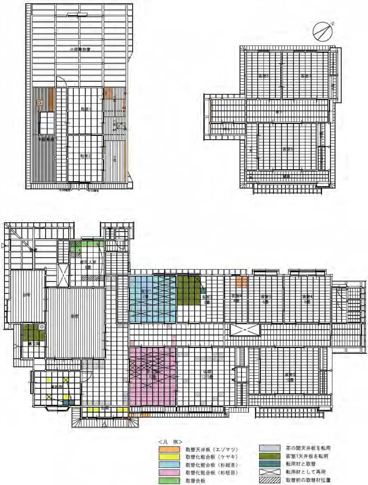
図 5-10 天井補修範囲図 (上:二階, 下:一階)
