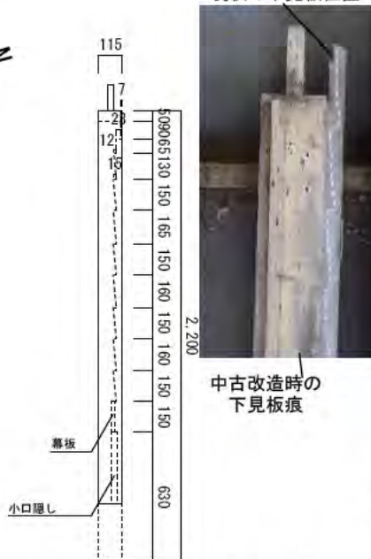
ま-七柱東面の中古の痕跡図
