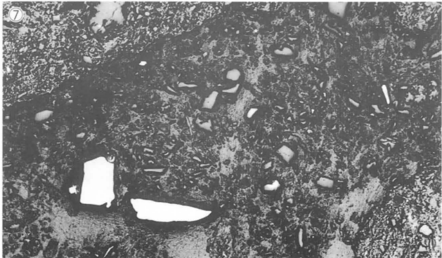
photo.7 椀形鍛冶滓・羽口の顕微鏡組織
