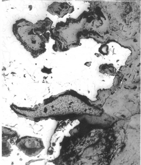
photo.6 含鉄鉄滓の顕微鏡組織
