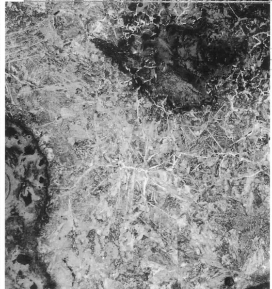
photo.3 鉄素材の顕微鏡組織
