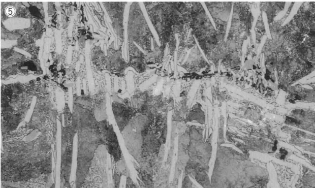
photo.3 鉄素材の顕微鏡組織
