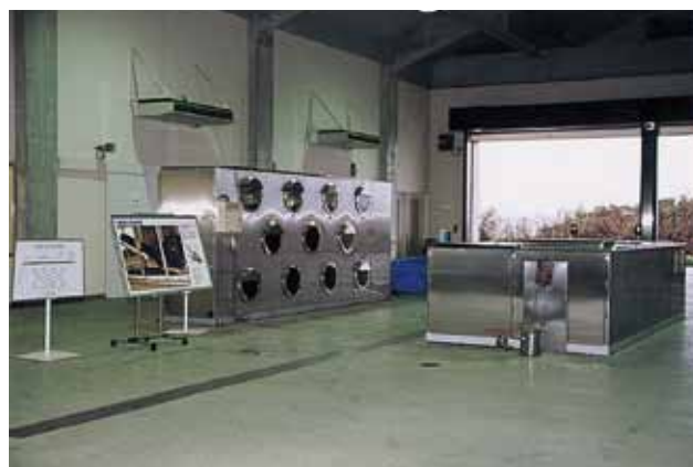
図版1 3号椀専用の保存処理装置
