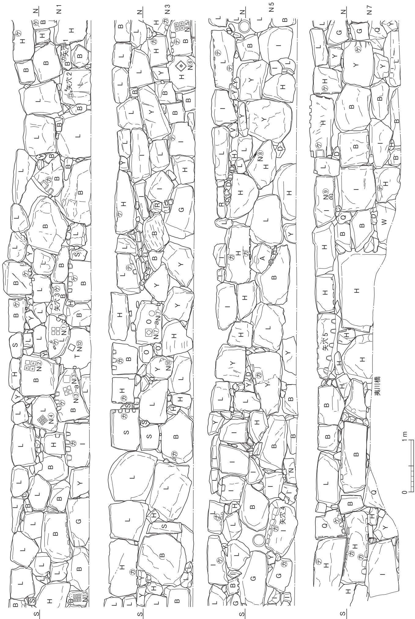
図22 二条城東側堀川石垣北(N)区の石種と矢穴跡の時期と刻印
