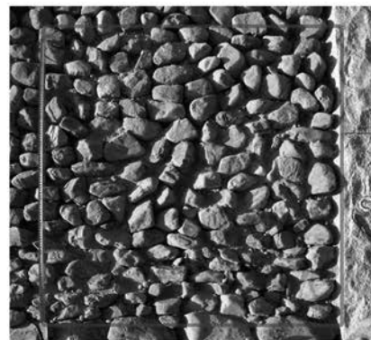
14 葺石復元試験の1m四方内の状況
