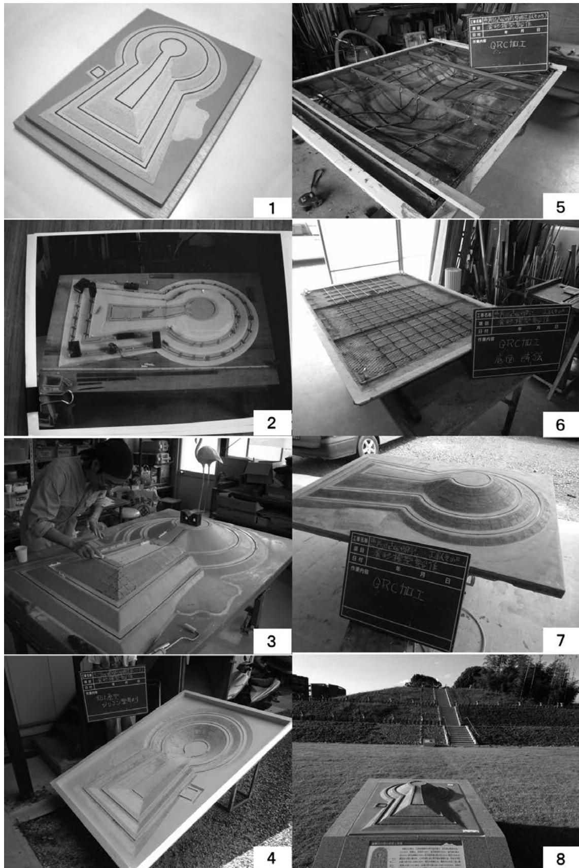
第72図 墳丘復元模型作製工程
