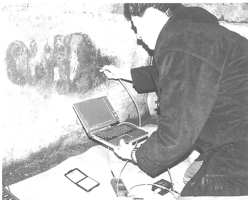
図4. ファイバーマルチチャンネル分光システムによる測色風景
