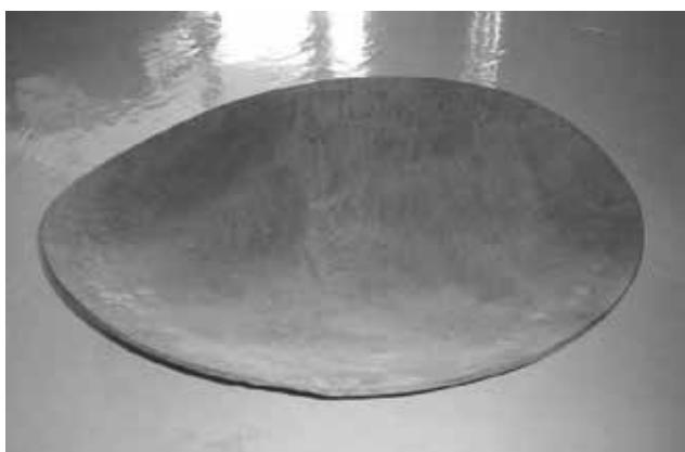
砂金が入った土砂や磨臼で磨り潰された鉱石粉を水の中で振り動かします。通称これをパンニングと言います。比重選鉱法により砂金だけに分離する手法で、この鉢はそれに用いるものです。直径約80cm。木製の汙鉢です。
