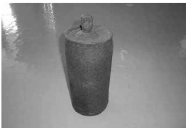
明治時代に入るとフランスから招聘されたコワニエにより水銀を使ったアマルガム法が導入され、微細な金まで採取することが出来るようになりました。アマルガムとなった金と水銀の合金は、坩堝に入れ、加熱し水銀を飛ばすと青金となります。この水銀を入れていたのが水銀壺です。
