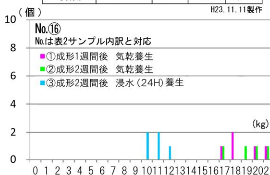
図3 圧壊硬度測定結果からみた平成23年度土間タタキ試験結果の品質向上
