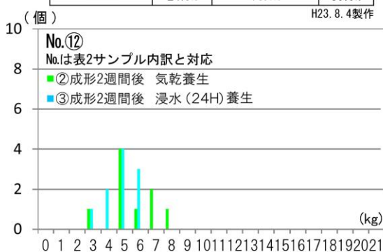
図3 圧壊硬度測定結果からみた平成23年度土間タタキ試験結果の品質向上
