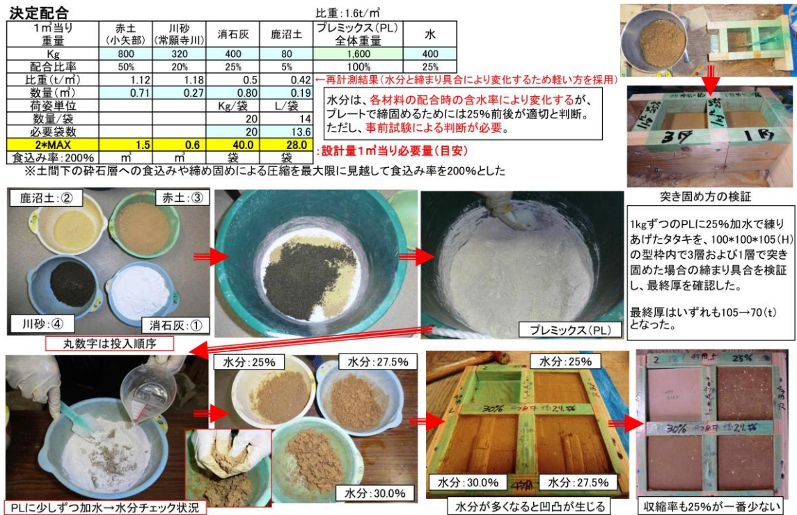
図4 決定された最適配合比と施工方法の検証試験
