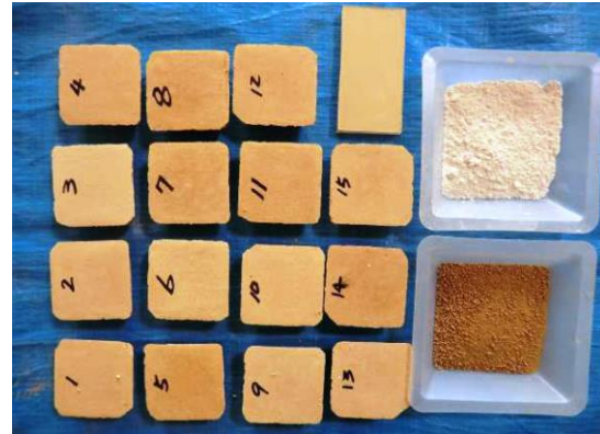
写真4 絞り込んだ配合（右上）と赤土（右下）、消石灰
