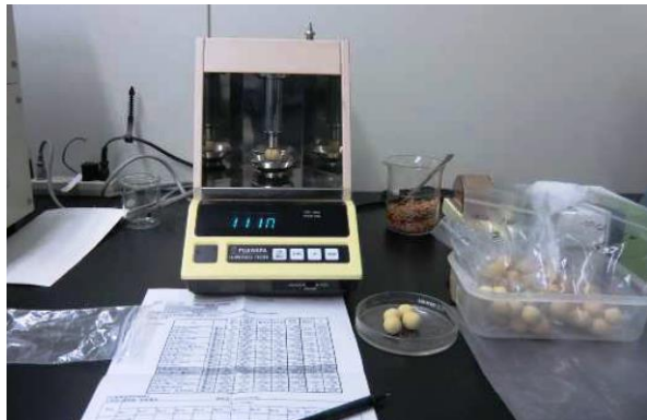
写真2 圧壊硬度測定試験
