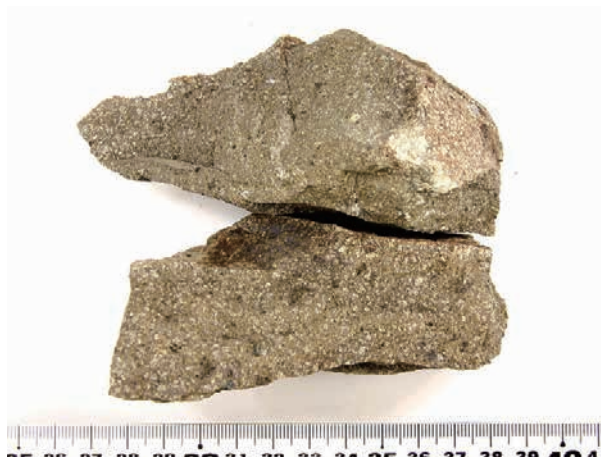
6. 試料6 岩下神社跡の裏手のガレ沢(十二原沢) 単斜輝石斜方輝石安山岩
