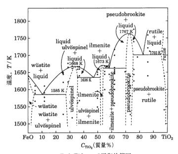
fig.1 FeO-TiO2 二元平衡状態図
