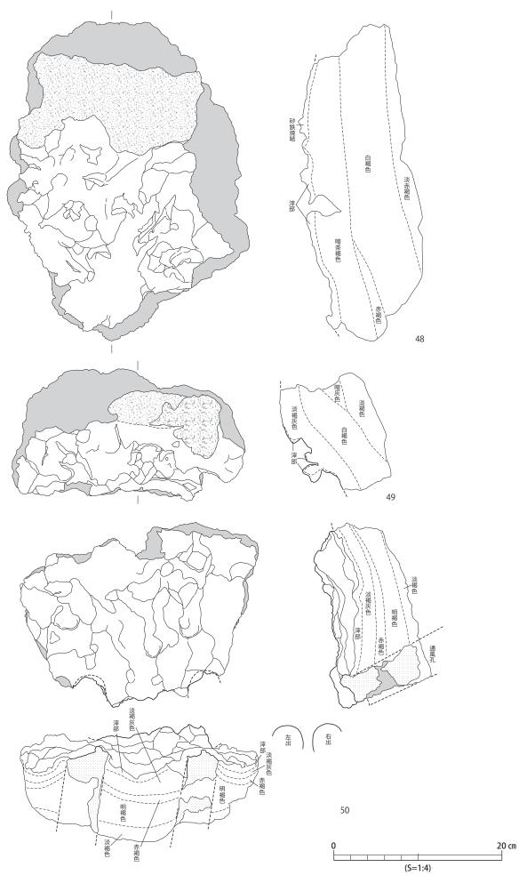
第38図 牧原Ⅱ遺跡出土・炉壁実測図16(下層・上~中部)
