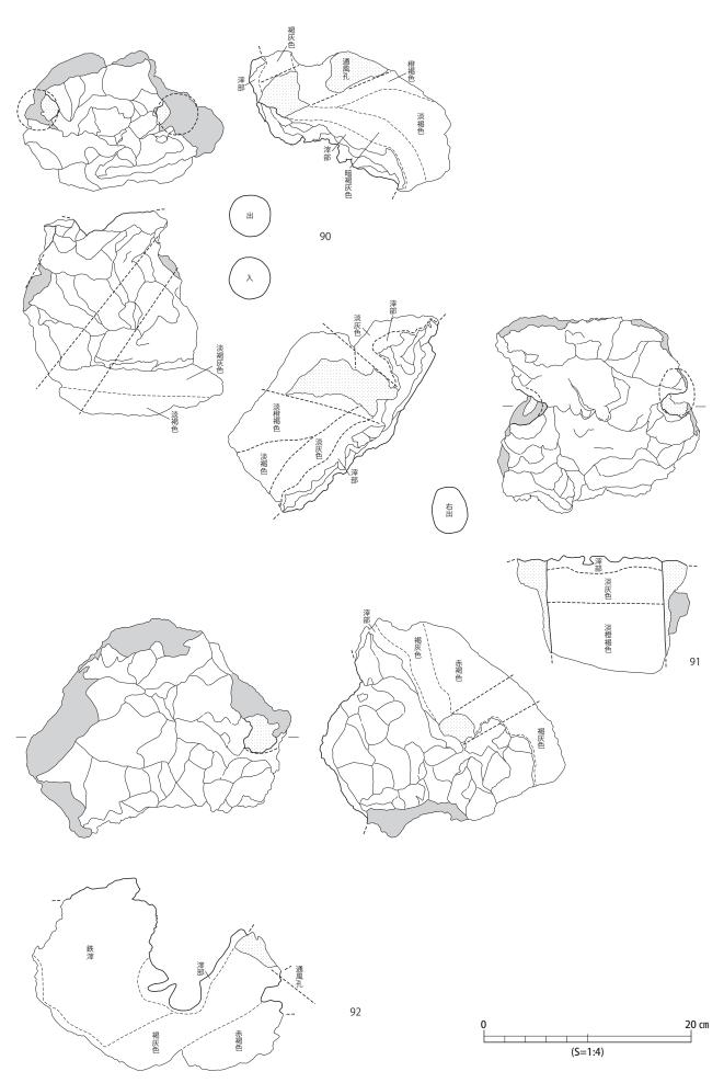
第53図 牧原Ⅱ遺跡出土・炉壁実測図31(下層・中~基底部)
