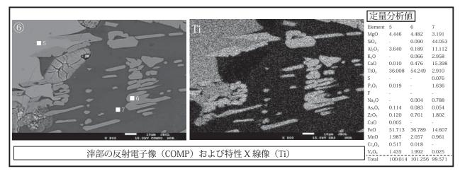
Photo.3 炉内滓の顕微鏡組織
