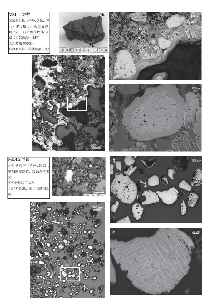
Photo.1 炉壁・砂鉄の顕微鏡組織
