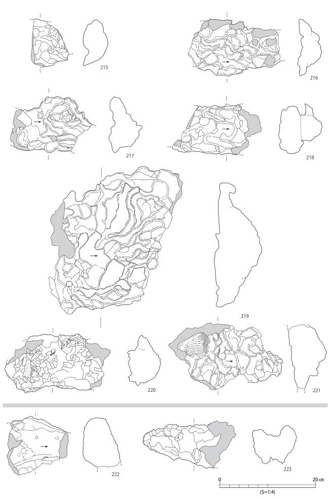
第75図 牧原Ⅱ遺跡出土・流動滓実測図2(上層・流動溝滓)
