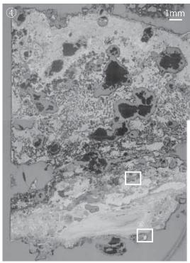
Photo.6 砂鉄焼結塊・炉内滓の顕微鏡組織
