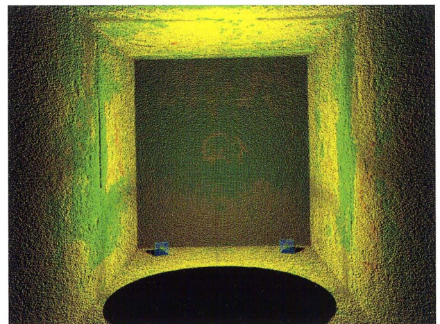
Fig.8 3D計測による点群データの輝度表示
