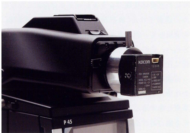
Fig. 31 ファインダーに取り付けたTVカメラ
