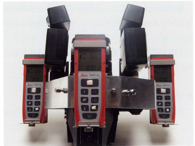
Fig. 24 三台の測距機の数字を合わせる
