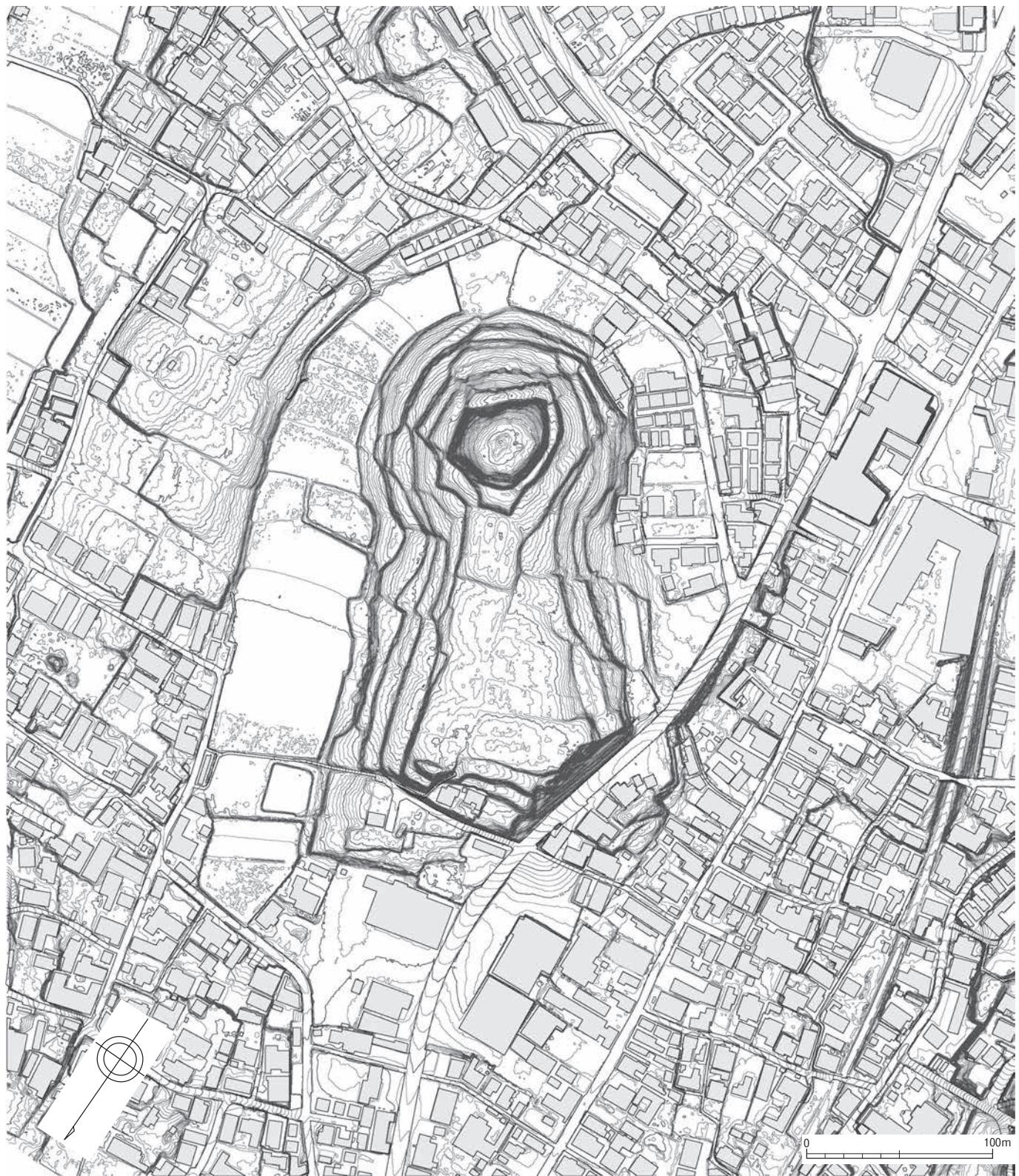
図 7 檜原丸山古墳墳丘測量原図 (50cmメッシュモデルからの20cmセンター)
