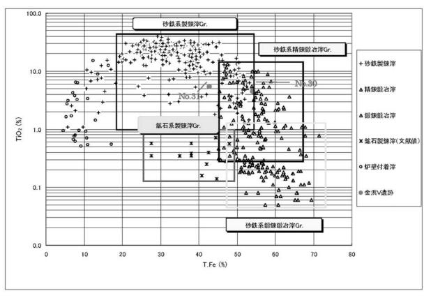
図2 製錬滓、精錬滓、及び鍛錬滓の分類
