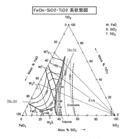
図 1 FeO-SiO2-TiO2系鉄滓の平衡状態図
