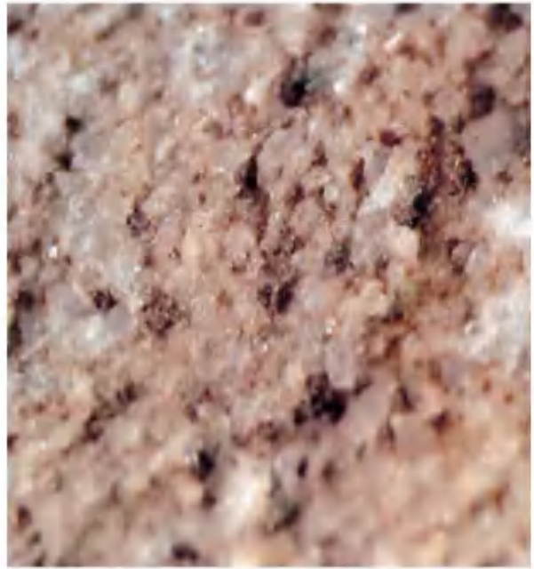
図3 破碎されたと考えられる角のある石英が多数観察される。また、粒子の淘汰は良好である
