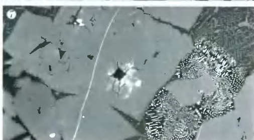
photo.2 鉄滓の顕微鏡組織
