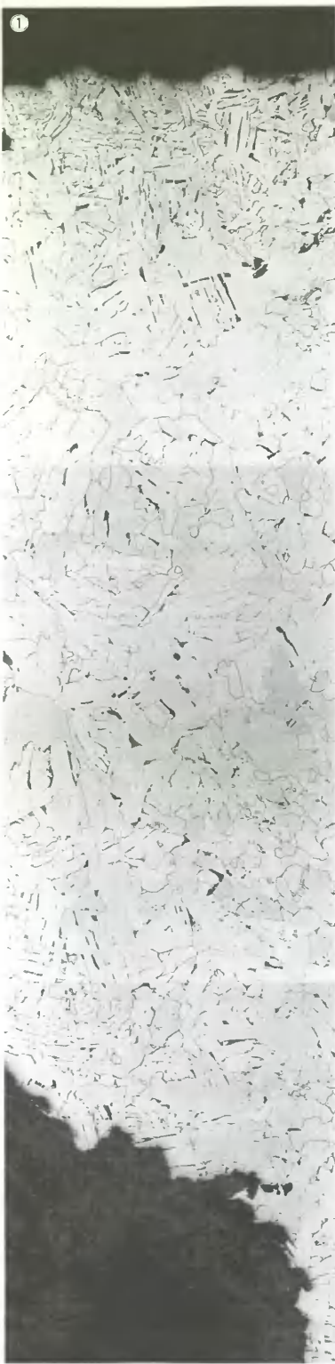
Photo. 6 鉄塊系遺物の顕微鏡組織 (×50)
