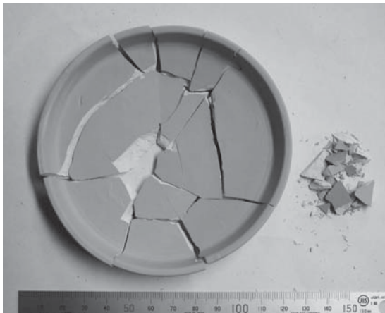
図10 カン製棒状ハンマーで打撃した皿 (右は打撃部直下の碎片：床に置いて裏面を打撃)
