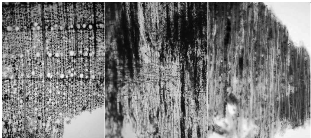
横断面 0.1mm 放射断面 0.1mm 接線断面 0.1mm ヤブツバキ No.15 西区F-7 S263 5層
