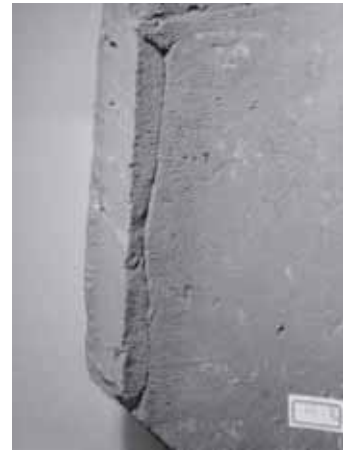
②丸瓦凹面の粘土板合わせ目
