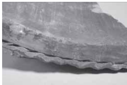
瓦表面に見える液だれの跡
