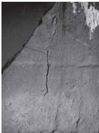
③平瓦凹面の粘土板合わせ目
