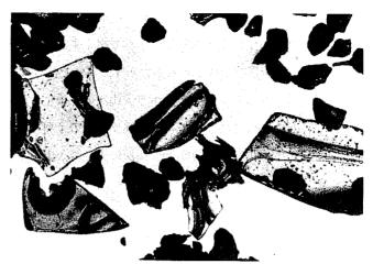
写真 1 アカホヤ火山灰の顕微鏡写真。 最大のガラス片の長径はおよそ0.7mm。
