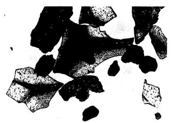
写真2 姶良Tn火山灰の顕微鏡写真。 最大の火山ガラス片の長径はおよそ1mm。
