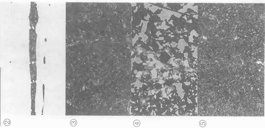
(23) UMK-11 ① 袋状鉄斧 ①×50 試料断面 ②×400 非金属夹杂物 組織、フェライト ③~⑤×200 試料断面 ③中央部:555HV ④側部:192HV ⑤皮部:548HV
