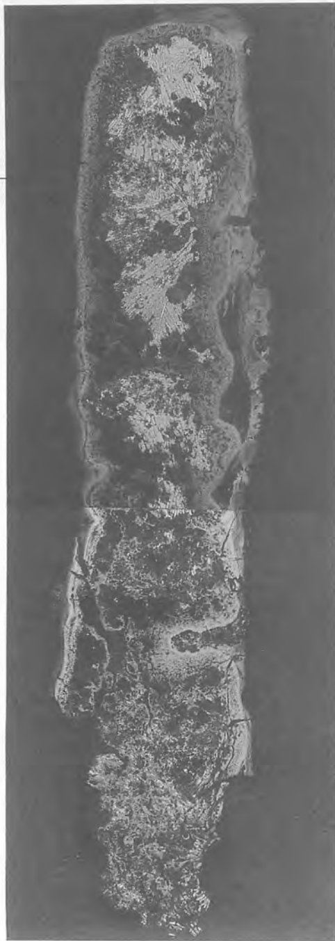
Photo. 39 鑄造鉄斧片(UMK-6)のマクロ組織(×20)
