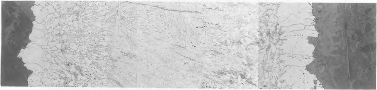
Photo. 31 鑄造鉄片の顕微鏡組織
